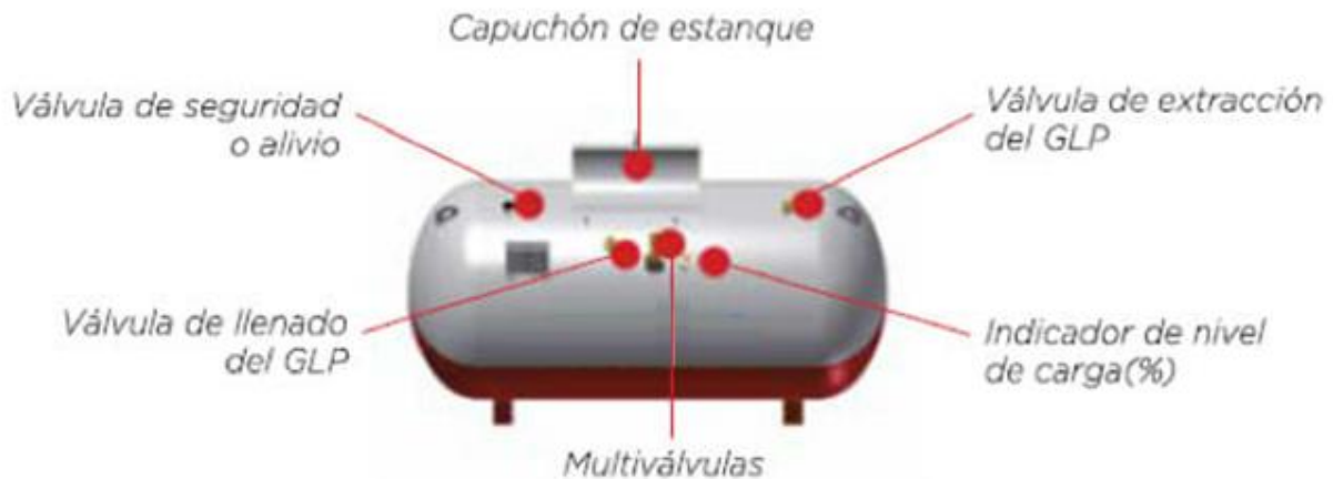
Ilustración 2 Elementos principales de un estanco de GLP
